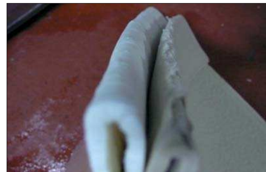
Bild 3: Die stabile Struktur wird deutlich bei der Nassfestigkeit nach der Filtration. Foto: Rosch
